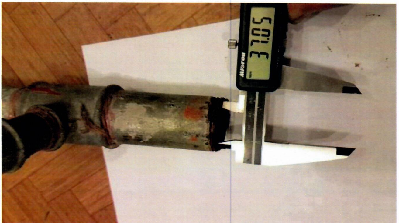
ФОТО 17 (измерение внутреннего диаметра трубы)
