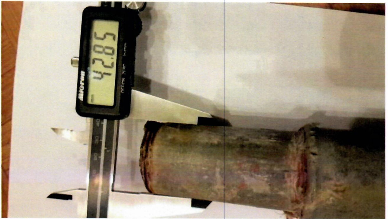
ФОТО 16 (измерение наружного диаметра трубы)
