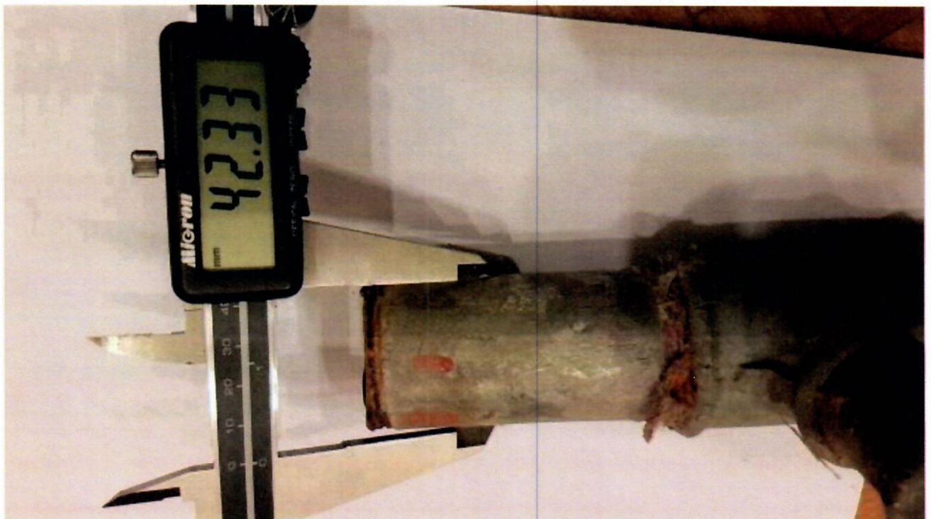
ФОТО 15 (измерение наружного диаметра трубы)
